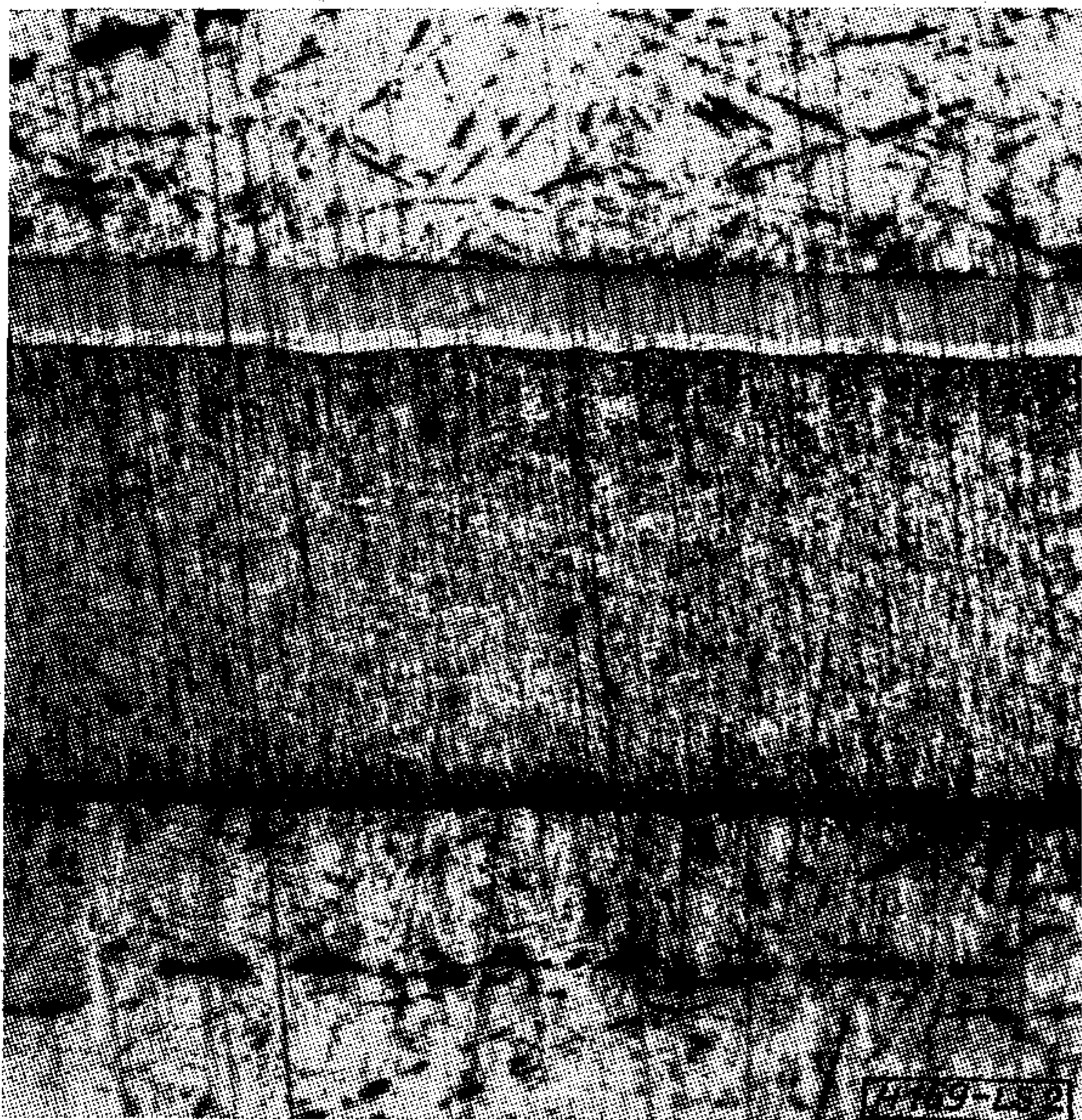
2. ábra. 70/30 Ag—Pd ötvözettel borított ónbronzzal közbeeső ezüstréteggel (~13X)
