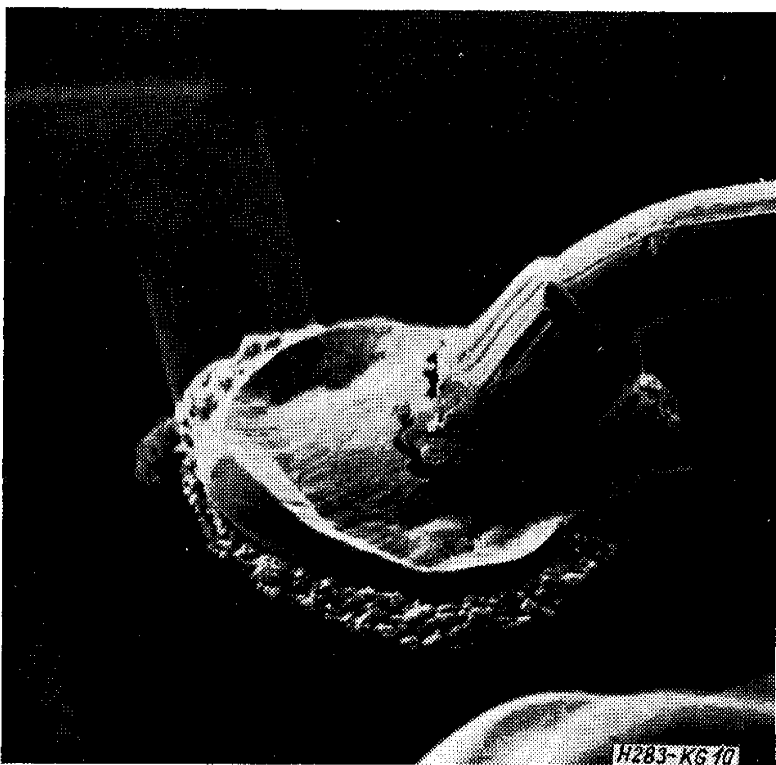
10. ábra. Selejtes termokompressziós kötés integrált áramkörön (PEM 300×)
