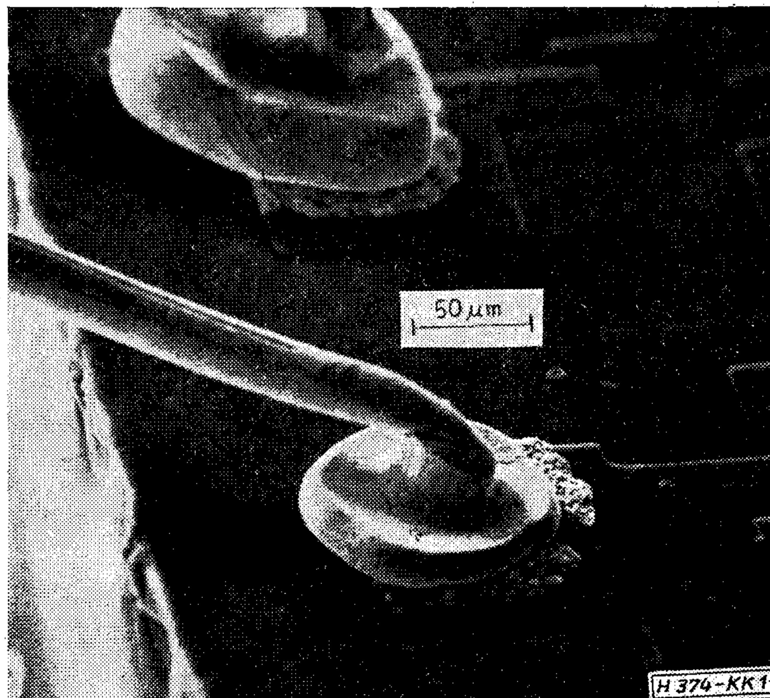
11. ábra. Erős fekete pestis SEM (pásztázó elektronmikroszkópos) felvétele két túllapított, repedt termokompressziós gömbkötés körül. Az Au_5Al_2 intermetallikus fázisok habosan laza szerkezete az élvilágítású felvételen jól megfigyelhető (Stefániay Vilmos felvétele)
