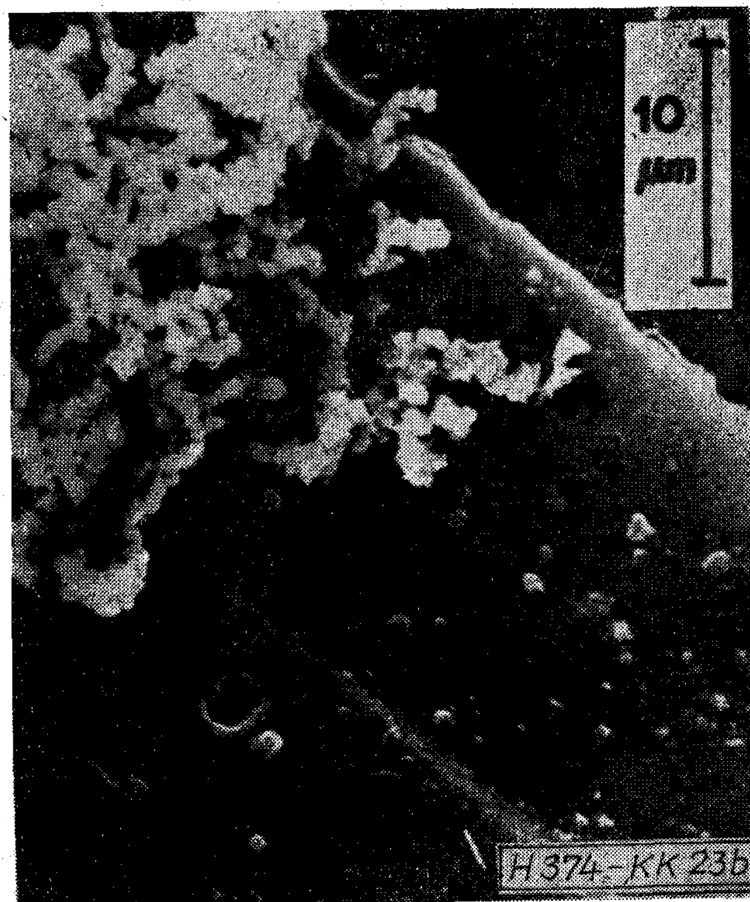
23. ábra. Korrózió egy Au-Al bondolás körül (a). A fekete nyilak mutatják a SiO 2 -re leelőgő kocsonyás Al(OH) 3 korróziós produktumot, amely sötétebb színével és féregszerű, durvább szemcseszerkezetével (b) erősen elüt a szintén jelenlevő pestistől (fehér nyilak) (TL 7472 N, fém-üvegház, 21 nap, 40 °C nedves-meleg klíma után a tok áteresztett, SEM felvételek)
